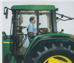
Vändbar förarplats samt vändbart säte för specialarbeten som t.ex. dikeningsarbeten eller lastning av timmer.
