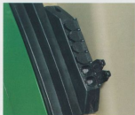
Nytt multi-eluttag med sex uttag för t.ex. monitorer, biltelefon och annan elektrisk utrustning.
