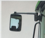
Teleskopiska backspeglar ger dig en god överblick över bakomvarande trafik eller tillkopplade redskap.
