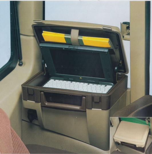
Nytt fältkontor - en avtagbar box för förvaring av bärbar dator eller biltelefon, viktiga anteckningar, fickräknare, pennor etc. Locket erbjuder en plan arbetsyta.
